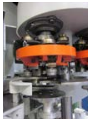
V-Station mit V-Rollen „abgedichtete Ausführung“
